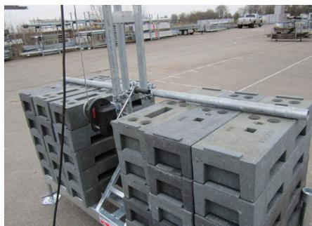
Ballastsicherung mit (Gerüstrohr 2 m und zwei Normalkupplungen)
